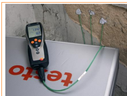
zdjęcie 1: do miernika należy podłączyć specjalnie zaprojektowaną sondę wartości U.
